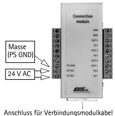
Anschluss für Verbindungsmodulkabel
